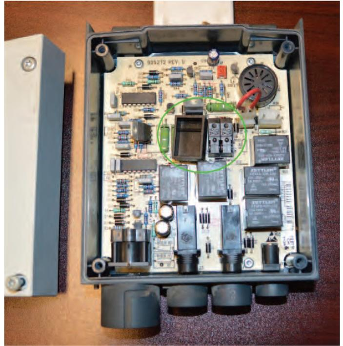
REMOVE THE COVER AND PLACE ON TABLE RIGHT-SIDE UP: NOTE POSITION OF EMERGENCY-SWITCH CAP
