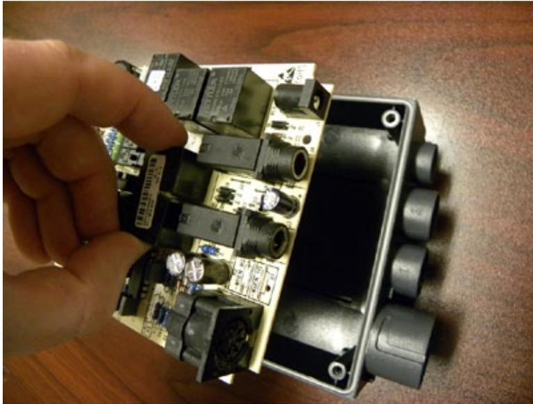
**REMOVE THE CONTROL BOARD FROM THE CONTROL BOX**
