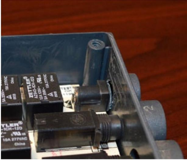
**PLACE THE CONTROL BOARD BACK IN PLACE INSIDE THE CONTROL BOX**
