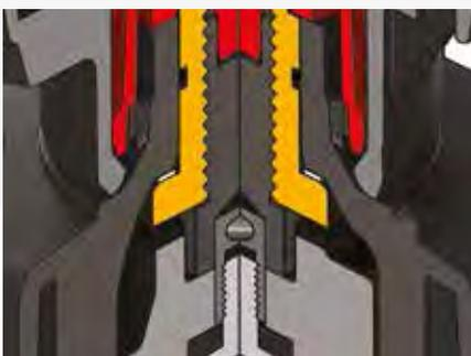
**Raccordement à broche flottante** entre la vis de commande et la membrane pour augmenter l'étanchéité et la durée de vie en évitant les concentrations de charge.
