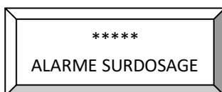
Il suffit d'appuyer sur **CAL/OK** pour sortir l'appareil de l'alarme.
