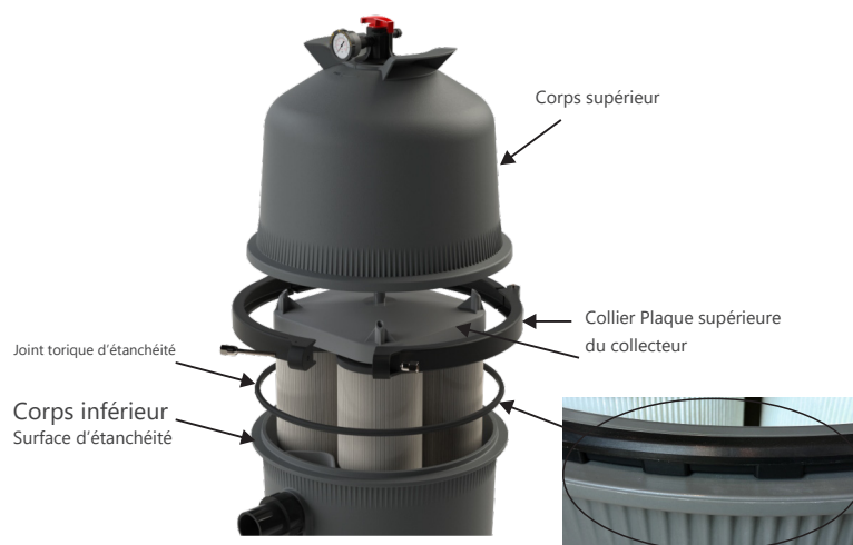
Figure 6 La face cannelée du joint torique en caoutchouc doit être orientée vers le bas
