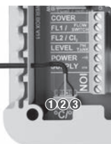
Sonda de temperatura ① vermelho ② amarelo ③ preto
