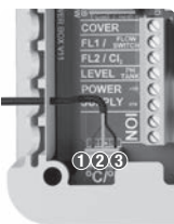
Sensore temperatura ① rosso ② giallo ③ nero
