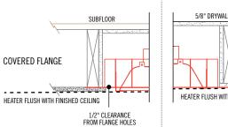
EXPOSED FLANGE HEATER FLUSH WITH FLANGE
