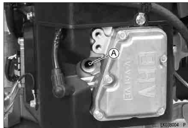
A. Orificio de la bujía de encendido
