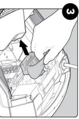
Tire de hacia atrás la tapa del impulsor para arriba. Limpie las impurezas atrapadas alrededor del impulsor. Vuelva la tapa del impulsor.
