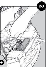
Abra los 2 tornillos con un destornillador corto.
