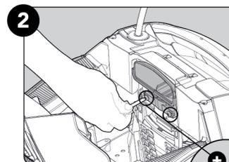
Au moyen d'un tournevis court, desserrez les 2 vis.
