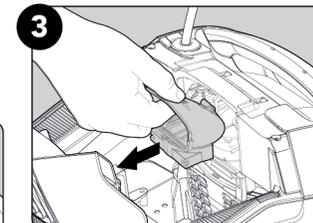
Tirez le couvercle de l'hélice vers l'arrière pour le dégager. Enlevez les déchets qui encombrant l'hélice. Réassemblez le couvercle de l'hélice.
