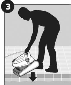
Coloque el limpiador en la piscina. Suelte el limpiador de piscina y deje que se sumerja en el fondo de la piscina. Asegúrese de que el cable flotante no está obstruido.
