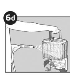
Nettoyez le panier de filtrage au moyen d'un jet d'eau.
