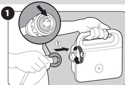
1 Conecte el cable flotante a la fuente de alimentación.
