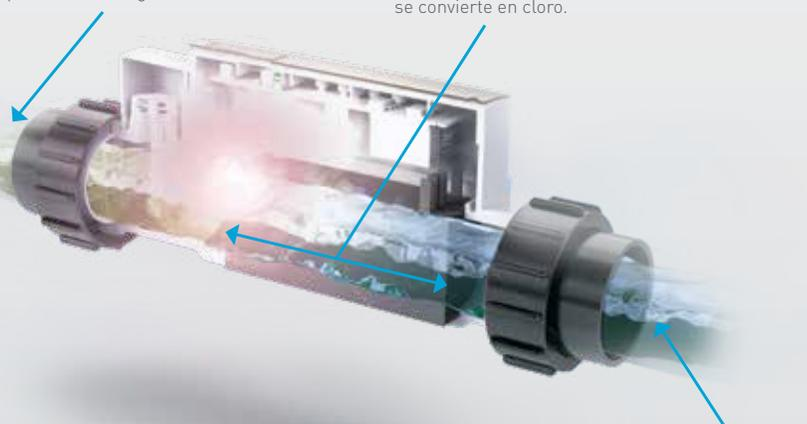
La cloración salina es un proceso por el cual se añade sal común (cloruro sódico) al agua de la piscina y mediante el clorinador de sal, se separa el cloro del sodio. El cloro desinfecta el agua y vuelve a combinarse con el sodio creando sal otra vez y así se repite el ciclo.
