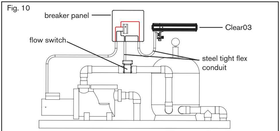
**THE CLEARO3 UNIT IS FACTORY SET TO 240VAC. THE CLEARO3 SHOULD BE WIRED TO RUN WITH THE FILTER PUMP WHICH CREATES THE AIR DRAW THROUGH THE UNIT NEEDED TO CREATE OZONE. DO NOT SET THE CLEARO3 TO RUN WHEN THE FILTER PUMP IS OFF.**
