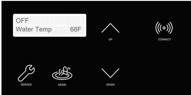
Figure 106. Réinitialisation Wi-Fi – Appuyez sur CONNECT
