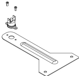
Figure 61. Limiteur de température interne - Réarmement manuel
