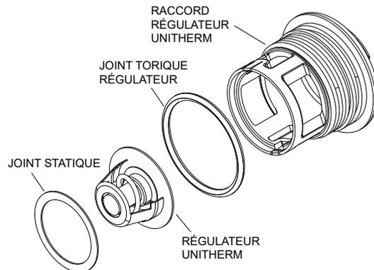
Figure 19. Régulateur Unitherm
