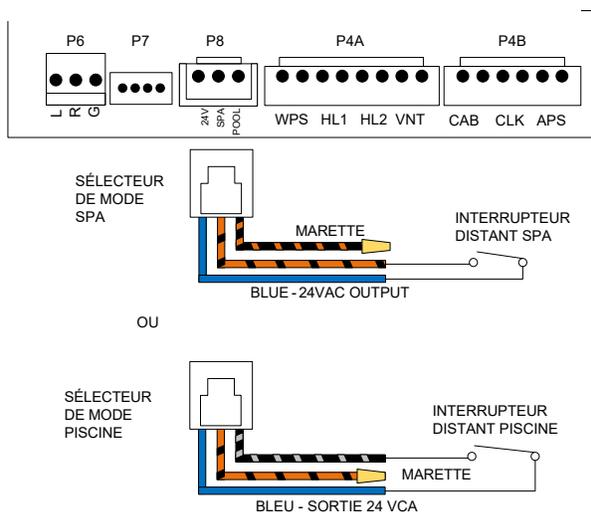
Figure 56. Harnais de câble 2 fils pour thermostat externe
