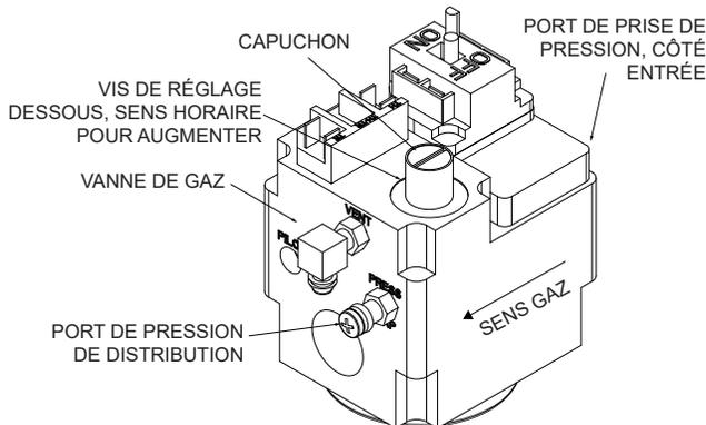
Figure 15. Réglage de la vanne du gaz
