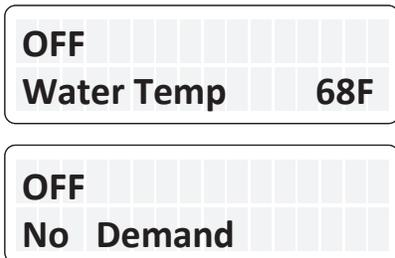
Figure 36. Alternance de l'affichage durant le chauffage
