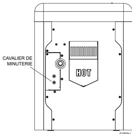
Figure 58. Emplacement des câbles de minuterie
