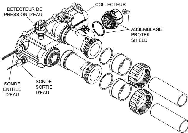
Figure 17. Distributeur d'entrée/sortie
