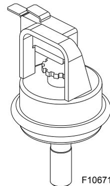
Figure 59. Assemblage du détecteur de pressions d'eau
