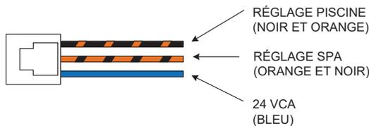
Figure 55. Harnais de câble 3 fils pour thermostat externe
