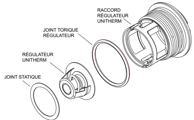
Figure 70. Régulateur Unitherm
