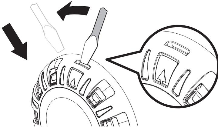
**3****ROTATE AND PULL OUT LIGHT ASSEMBLY**
