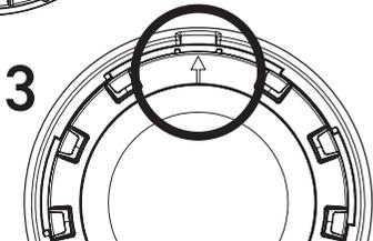
2: ENSURE THE 12 O'CLOCK MARKER ON THE CLAMP RING LINES UP WITH THE 12 O'CLOCK MARKER ON THE LIGHT ASSEMBLY.
