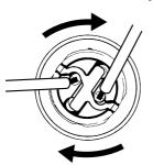
4: TWIST THE SCREW TERMINAL AND LOOP CABLE ENDS UNDER THE STRAIN RELIEF CLIP
