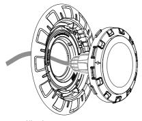
ARROW ALIGNMENT -SHOWING UNLOCKED POSITION
