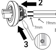
**3:** USE A FLAT BLADE SCREWDRIVER TO TIGHTEN THE FASTENERS ON EITHER SIDE OF THE SCREW TERMINAL
