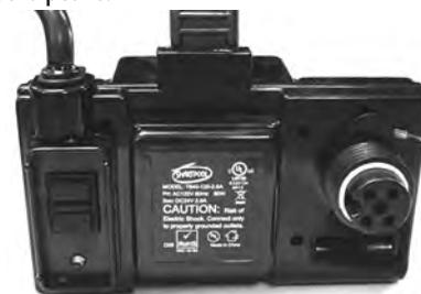
Pour un cycle de nettoyage rapide, placer le robot dans la piscine. Mettre l'interrupteur en position haute, un voyant vert doit s'allumer. Le nettoyeur débute un cycle de nettoyage d'une heure de la piscine.
