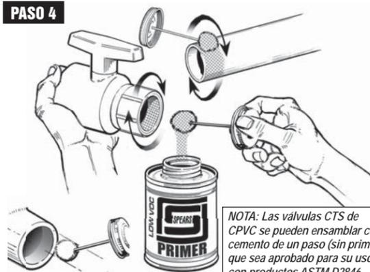
NOTA: Las válvulas CTS de CPVC se pueden ensamblar con cemento de un paso (sin primer) que sea aprobado para su uso con productos ASTM D2846. Verifique los códigos locales; omite el Paso 4.
