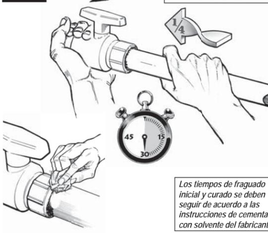
Los tiempos de fraguado inicial y curado se deben seguir de acuerdo a las instrucciones de cementar con solvente del fabricante.
