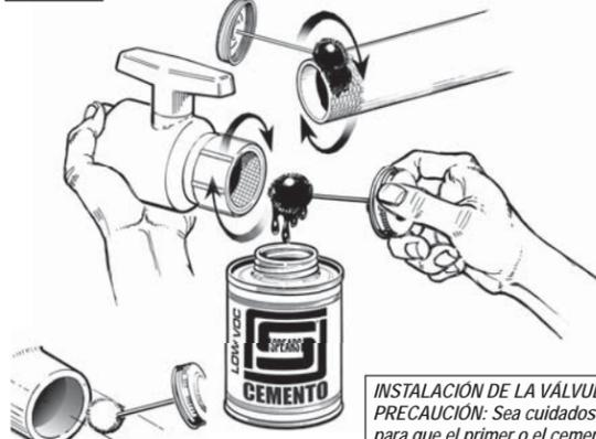
INSTALACIÓN DE LA VÁLVULA PRECAUCIÓN: Sea cuidadoso para que el primer o el cemento solvente no caiga o entre en contacto con los componentes internos de la válvula.
