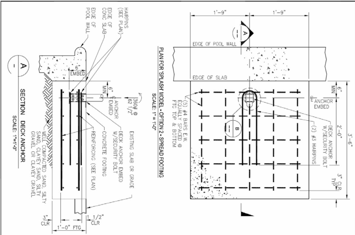
PLAN FOR SPLASH MODEL - OPTION 2 - SPREAD FOOTING
