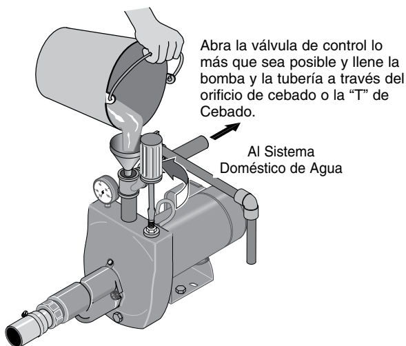
Figura 15: Abrir la Válvula de Control
