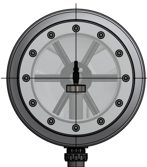
PVC-Entleerung mit Muffe 3/4"-Anschluss im Fuss
