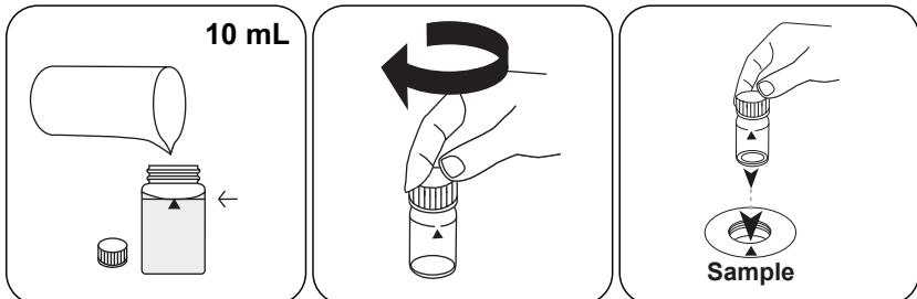
Remplissez une cuvette de 24 mm de **10 mL d'échantillon**.
