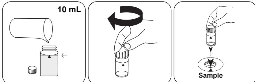
Remplissez une cuvette de 24 mm de **10 mL** d'échantillon.
