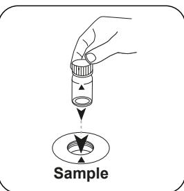
Placez la cuvette réservée à l'échantillon dans la chambre de mesure. Attention à la positionner correctement.
