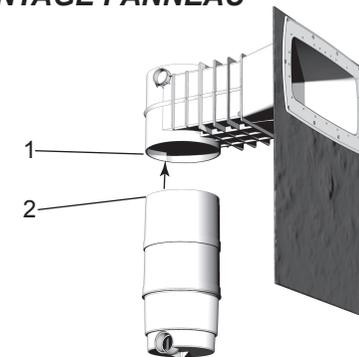
La cuve est à coller après avoir fixé le boîtier sur la paroi; appliquer la colle PVC sur 1 et 2, et placer la cuve suivant le schéma.
